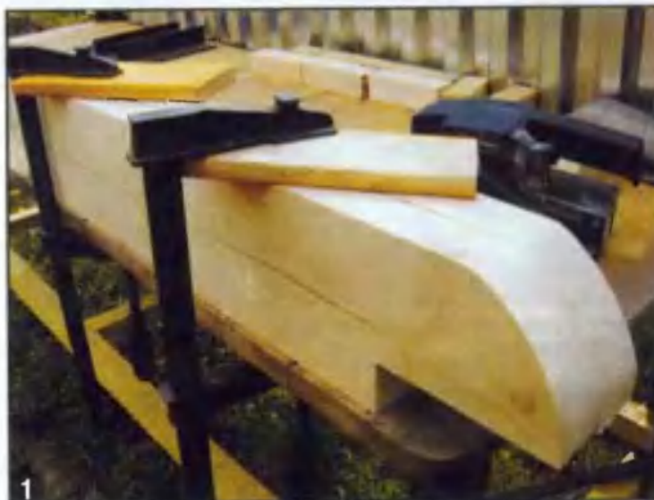
Нижние углы поперечных брусков каркаса крыши для красоты я скруглил, а в верхней части выпилил паз для соединения с продольными брусками.
