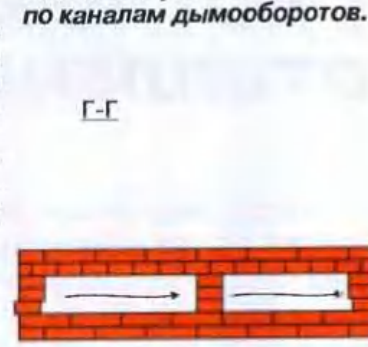
Рис. 2. Разрезы печи по каналам дымооборотов.
