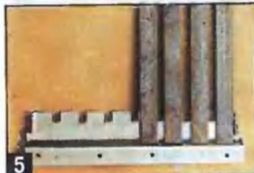
5 Колосниковая решётка представляет собой два S-образных кронштейна, выгнутых из листовой стали, на нижние полки которых свободно уложены стальные полосы. Язычки, отогнутые на нижних полках кронштейнов, не позволяют половсам смещаться друг относительно друга.
