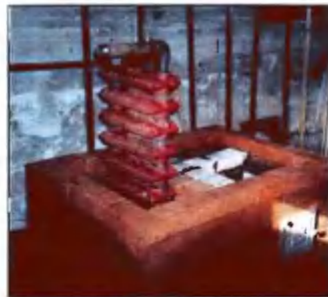
Водогрейный котёл — главная деталь этой печи.
