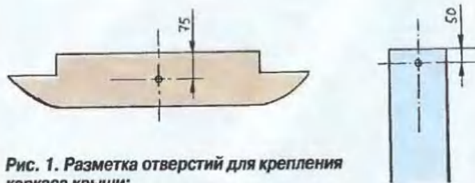
Нижние углы поперечных брусков каркаса крыши для красоты я скруглил, а в верхней части выпилил паз для соединения с продольными брусками.
