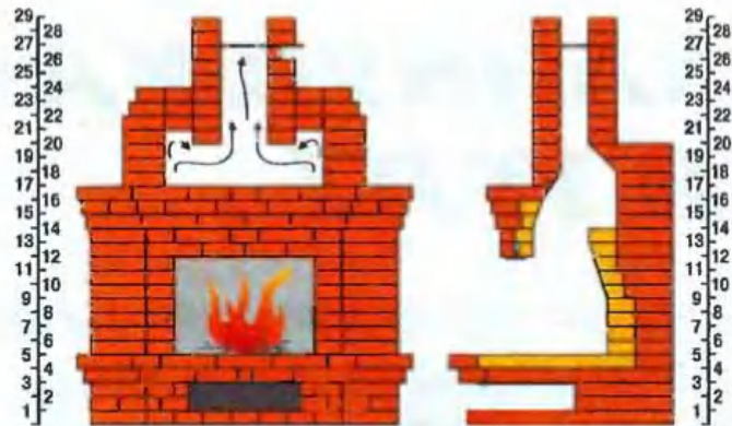
Рис. 2. Разрезы камина по осям А—А и Б—Б.
