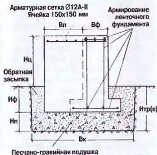
Конструкция совмещенного фундамента дома и печи (камина): Вп — ширина цокольной части фундамента печи (камина); Вф — ширина цокольной части фундамента дома; Нц — высота цокольной части фундамента; Нф — глубина заложения фундамента; Нп — толщина противопучинной подушки; Нтр(к) — глубина траншеи (котлована); Вк — ширина котлована.
