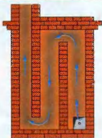
Вертикальная схема дымоходов
